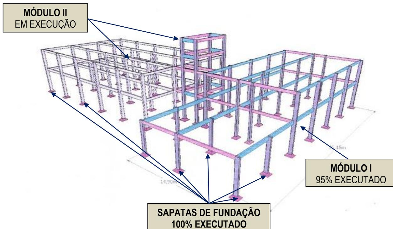
Após a conclusão da Estrutura Pré-moldada com a montagem do **Módulo II**, o próximo passo será a construção das lajes e vigas de baldrame. Essa etapa deverá contar com recursos que serão captados junto a Prefeitura Municipal de Palhoça, parceira na construção.
